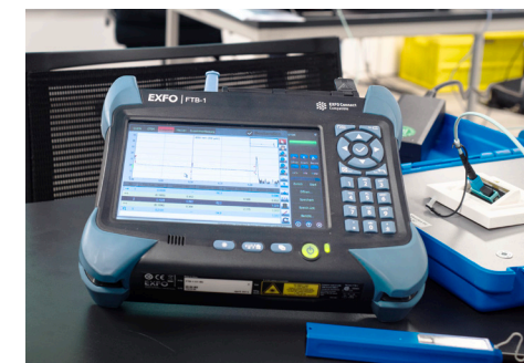
LWL MESSTECHNIK OTDR MESSUNGEN
