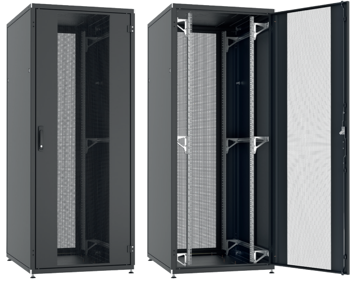
Serverschrank 42HE, Breite 800 mm x Tiefe 1200 mm Front- und Rücktür Stahl, perforiert (80 %), 1-teilig mit Schwenkhebel
