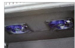
2 x Super-Silent Lüfter im Dach, zusätzlich entkoppel
