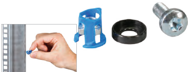
Die Käfigmutter wird von vorn mit einer 45°-Drehung ins Profil eingesetzt
