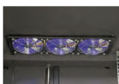
Hinterer Dachbereich mit 3 x Super-Silent Lüfter
