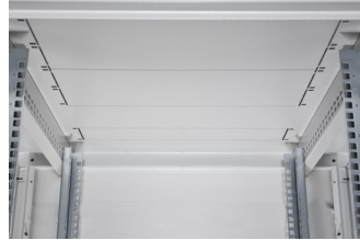
Dach- und Bodenblech mit vier vorgestanzten Ausbrüchen zur Kabeleinführung (vorn/hinten/links/rechts)
